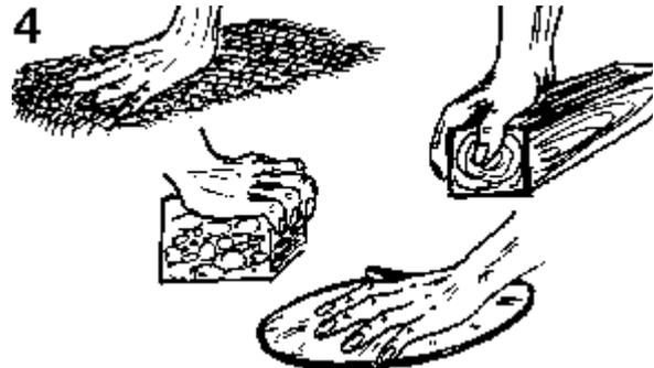
*Bild 3:* Lege vor dich auf den Tisch einen blanken Metalldeckel (ein Stück Blech) und je ein Stück Styropor, Teppichboden und Weichholz. Alle Teile müssen zuvor mehrere Stunden im gleichen Raum (im Schatten) gelegen haben.
